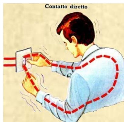
essere ricoperte in tutta la loro estensione con un materiale isolante o poste dietro involucri in grado di assicurare un grado di protezione sia da contatti da corpi estranei che da sostanze liquide come riportato nella norma CEI 64-8.
