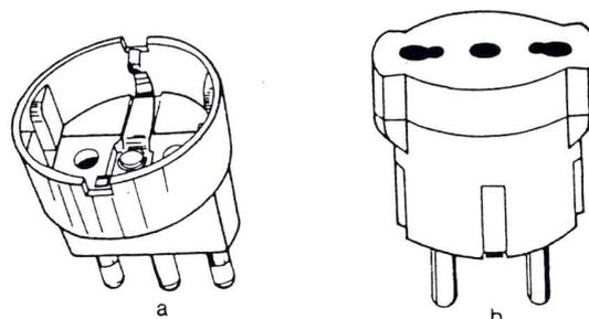
Gli adattatori multipli consentiti dalle norme sono quelli con due sole prese laterali. L'altro tipo, con una terza presa parallela agli spinotti, viene considerato pericoloso perché consente l'inserimento a catena di più prese multiple. Il pericolo deriva dalla possibilità di superare la corrente massima sopportabile dalla presa e dalla possibilità di cedimento meccanico della presa e degli adattatori a causa del peso eccessivo sugli alveoli.
